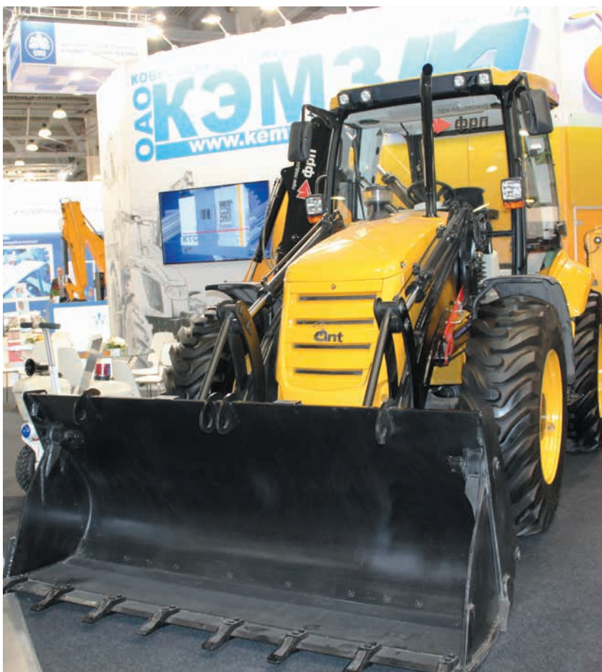
Многоцелевой колесный экскаватор-погрузчик ANT 2321
