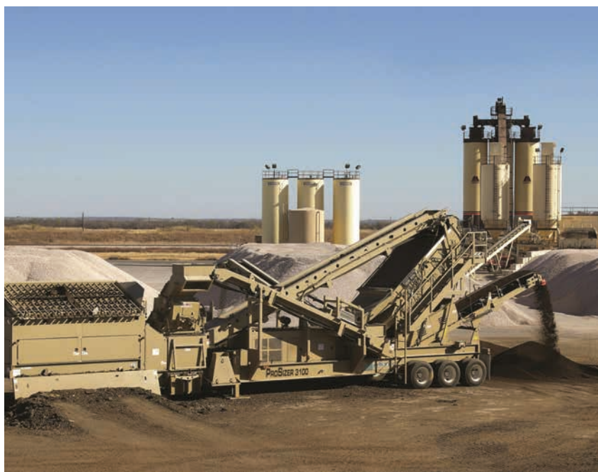
Мобильная установка ProSizer 3100 – идеальное решение для переработки РАП
