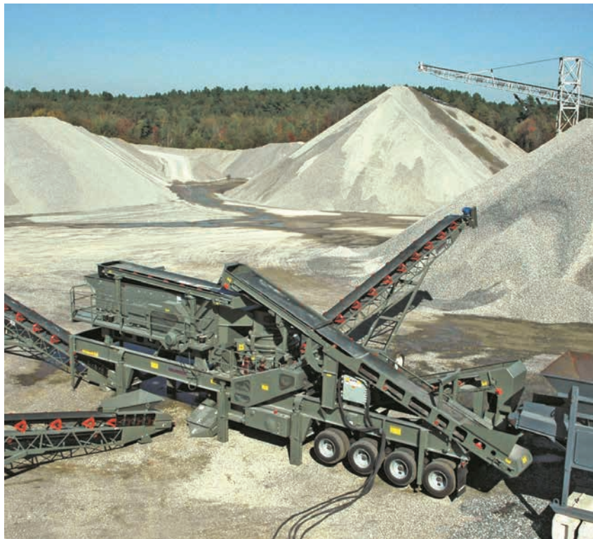
Мобильная установка замкнутого цикла TelSmith 44CCP – универсальное решение для подготовки щебня на АБЗ
