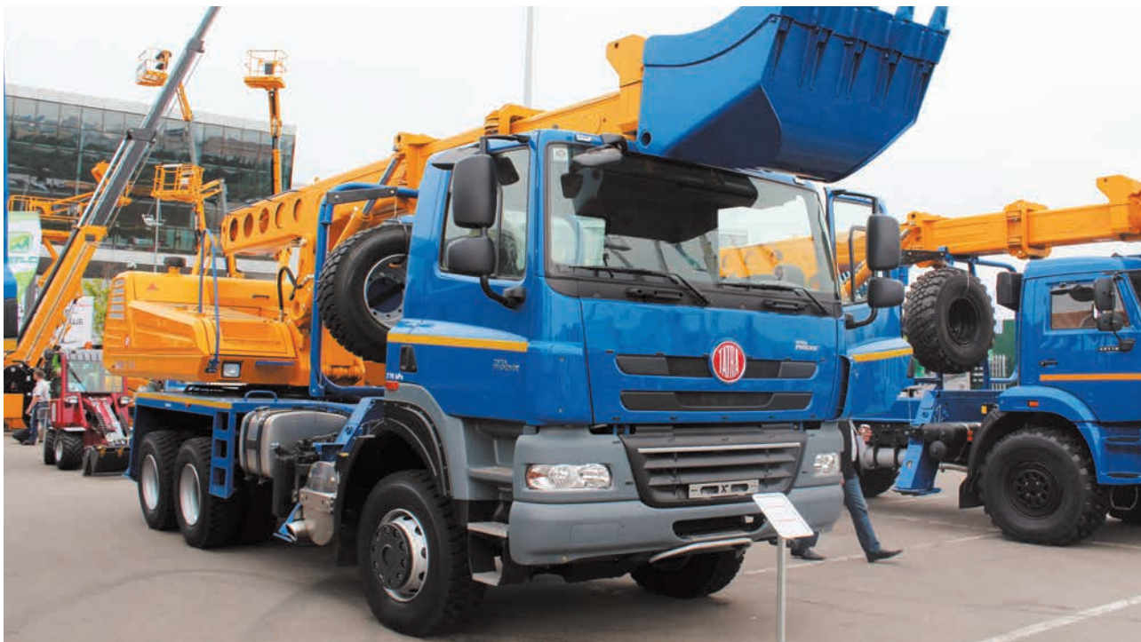
Экскаватор-планировщик UDS-114 на шасси Tatra T158 8P5R32
