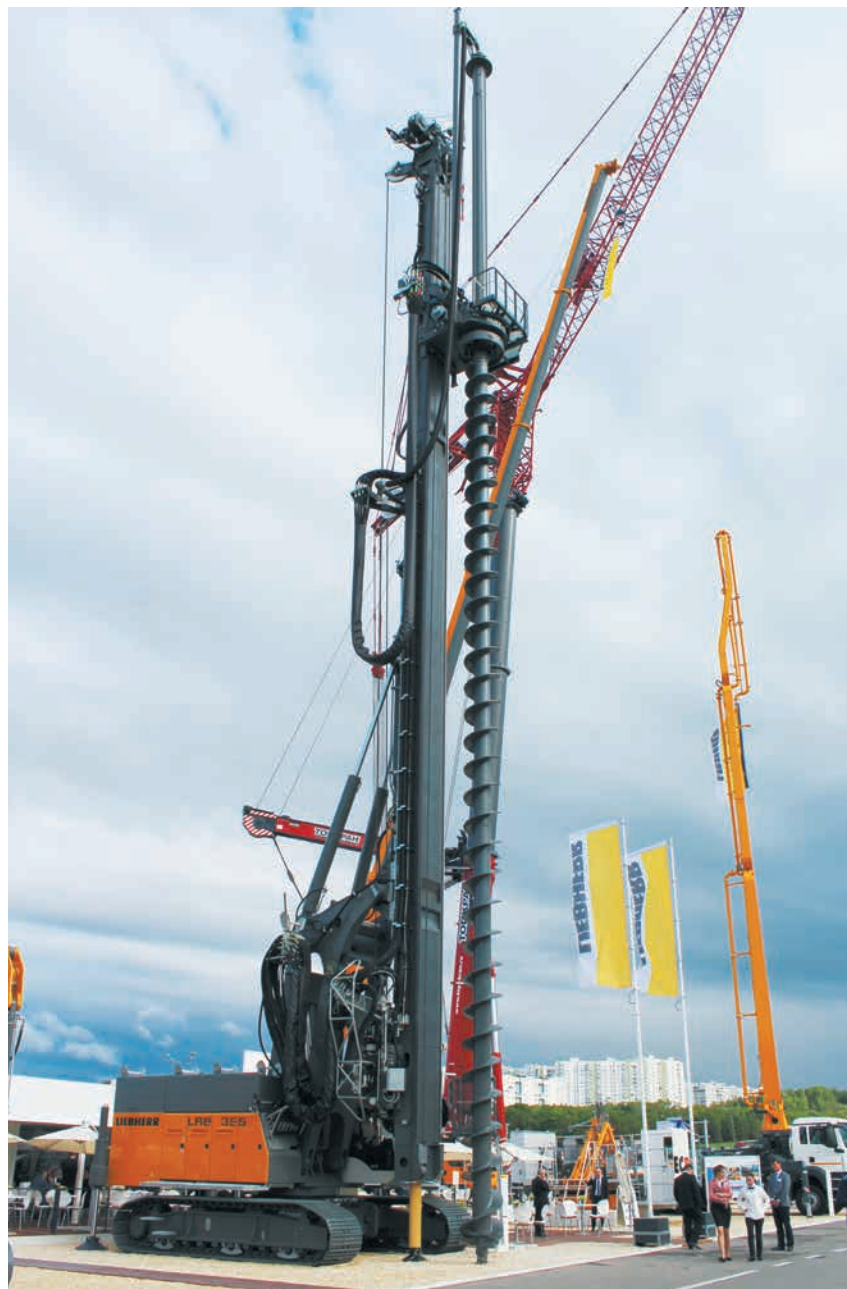
Сваебойная и буровая установка Liebherr LRB 355
